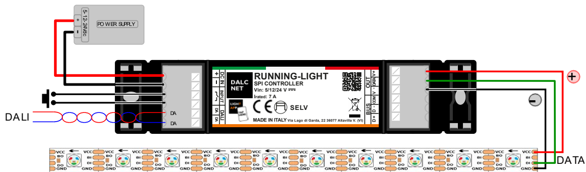
Figura 2: Schema di collegamento per carichi LED digitali
